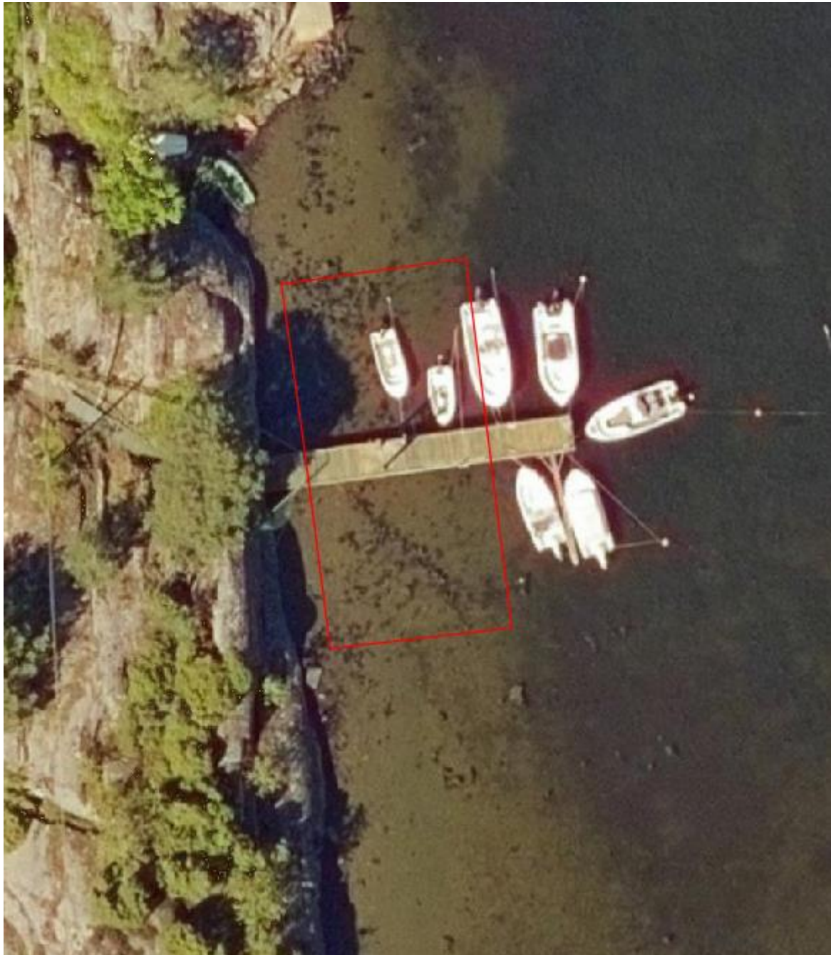
Figur 2. Flybilde av bryggeanlegget, som viser hvor grunt det har blitt under den innerste 2/3 av brygga. Tynn rød strek angir det arealet som ønskes mudret.
